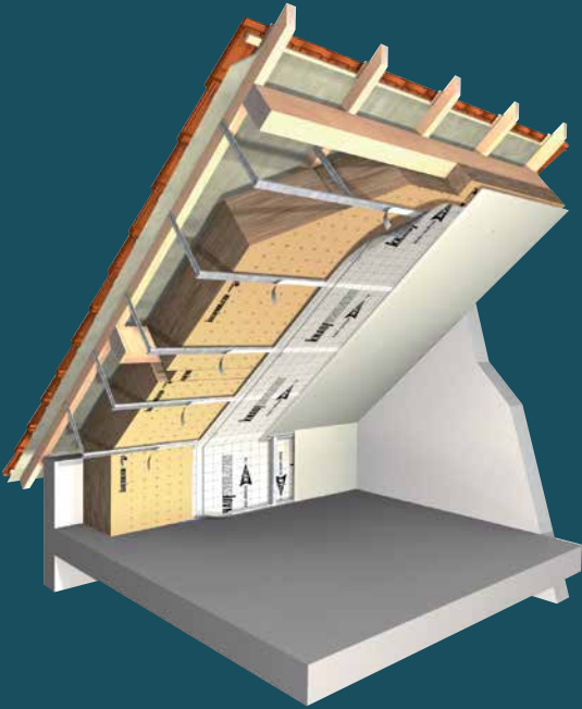
ISOLATION DE RAMPANT ET PIED DROIT EN COMBLES AMÉNAGÉS
