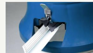
**1.** Metallschutzschienen passend ablängen und durch den mit pastöser Spachtelmasse (z. B. Superfinish) gefüllten Spachteltrichter Hopper ziehen.
