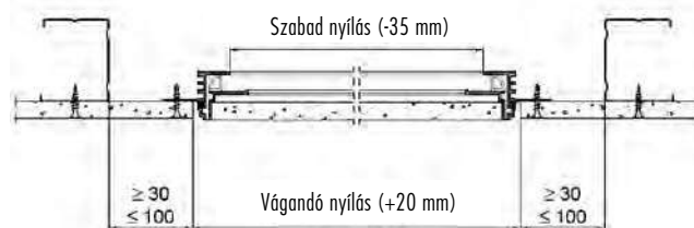
Beépítési vázlat csapóvíz esetén
