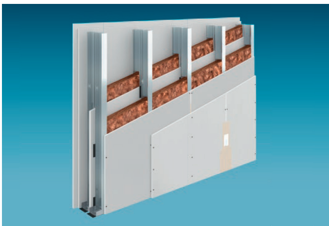
W115W.ee topeltkarkassvahesein, keskel 5. plaadikiht, postid isoleeritud või õhkvahega
