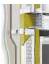
Enojna podkonstrukcija, s prezračevalnim kanalom – perforirani profili
