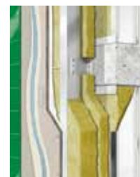
Dvojna podkonstrukcija z neprekinjenimi profili
