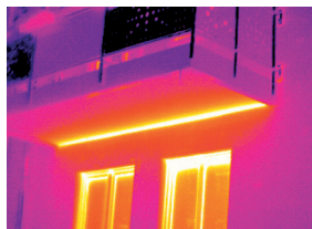
არასაკმარისი იზოლაცია ფანჯრების ელემენტებს შორის განაპირობებს ენერჯის კარგვას.
