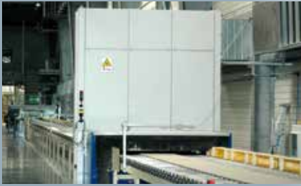
Produktionskontrolle mit dem Röntgenscanner
