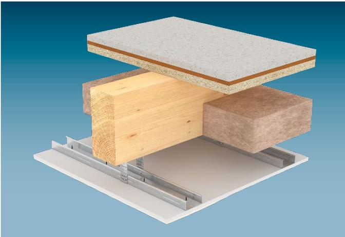
**D152.de/D152A.de** Knauf Platten werden auf eine Metall-Unterkonstruktion aus Stahlblechprofilen CD 60/27 als Tragprofile (einfacher Profilrost) oder als Grund- und Tragprofile (doppelter Profilrost) geschraubt. Die Befestigung der Unterkonstruktion erfolgt mit Abhängern an den Holzbalken.
