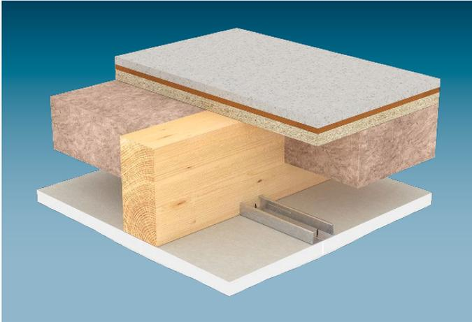
**D150.de/D150A.de** Knauf Platten werden mit Schnellbauschrauben direkt an die Holzbalken geschraubt.
