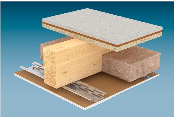
**D153.de/D153A.de** Knauf Platten werden auf eine Metall-Unterkonstruktion aus Federschiene oder Hutprofil geschraubt. Die Befestigung der Unterkonstruktion erfolgt mit Knauf Schnellbauschrauben direkt an die Holzbalken.
