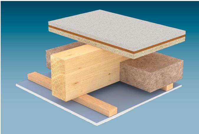
**D151.de** Knauf Platten werden auf eine Holz-Unterkonstruktion aus Traglatten (einfacher Lattenrost) geschraubt. Die Befestigung der Unterkonstruktion erfolgt entweder mit Knauf Schnellbauschrauben direkt an die Holzbalken oder mit Abhängern.
