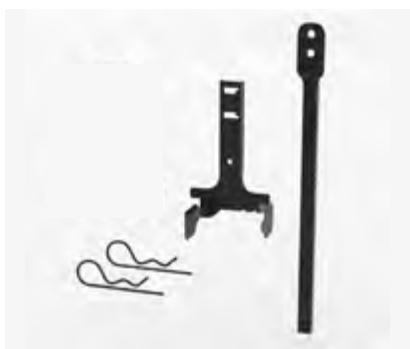
Nonius ophæng, C5 Anvendes til nedhængte lofter, hvor der kan være vindbelastning. C5 Nonius underdel, 40 kg fastskrues til CD-profilet.
