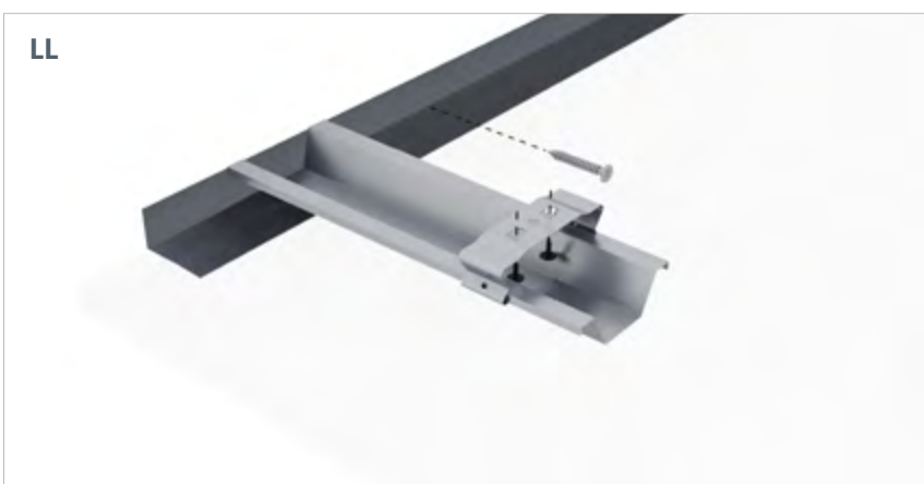
Monteringsprofilerne S 25 fastklemmes i lydbøjlerne. Monteringsprofilerne fastskrues til hver anden lydbøjle med skrue R/R 13. Afstanden c/c mellem monteringsprofiler og disses fastgørelser fremgår af tabellen på side 179.
