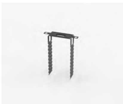
Direkte ophæng, C5 Anvendes til direkte monterede lofter. Max 40 kg pr. ophæng.
