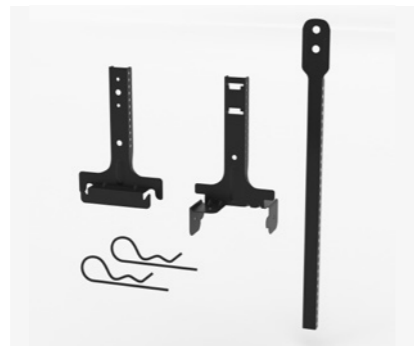
Noniuspendel C5 Används för nedpendlade undertak som kan utsättas för vindlast. C5 noniuspendel, underdel 40 kg, skruvas fast i CD profilen.
