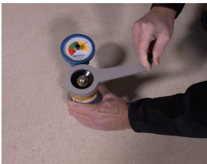
Grafika 51: Badanie wytrzymałości na odrywanie
