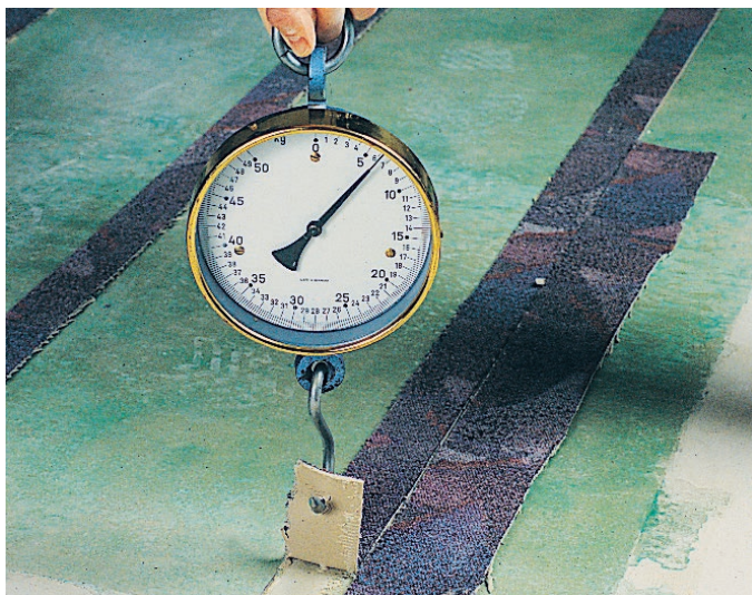
Grafika 50: Próba sklejania i badanie odporności na oddzieranie
