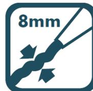
2. Aplicar um cordão contínuo de 8mm de diâmetro sobre o substrato.
