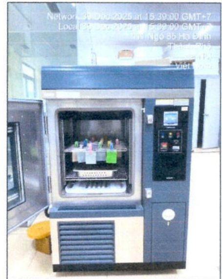
Vị trí mẫu thử trong buồng thử nghiệm (Position of Specimens in the test chamber)
