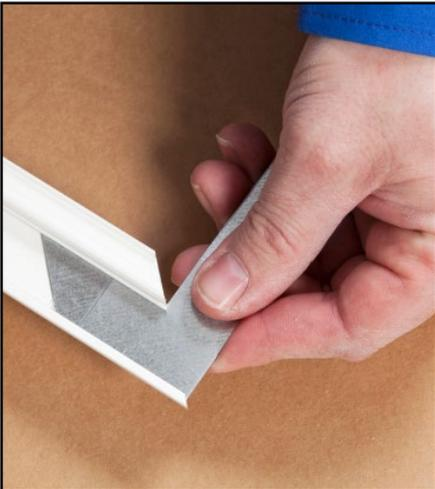
Je zwei Eckverbinder in die kurzen Rahmenteile einschieben.
