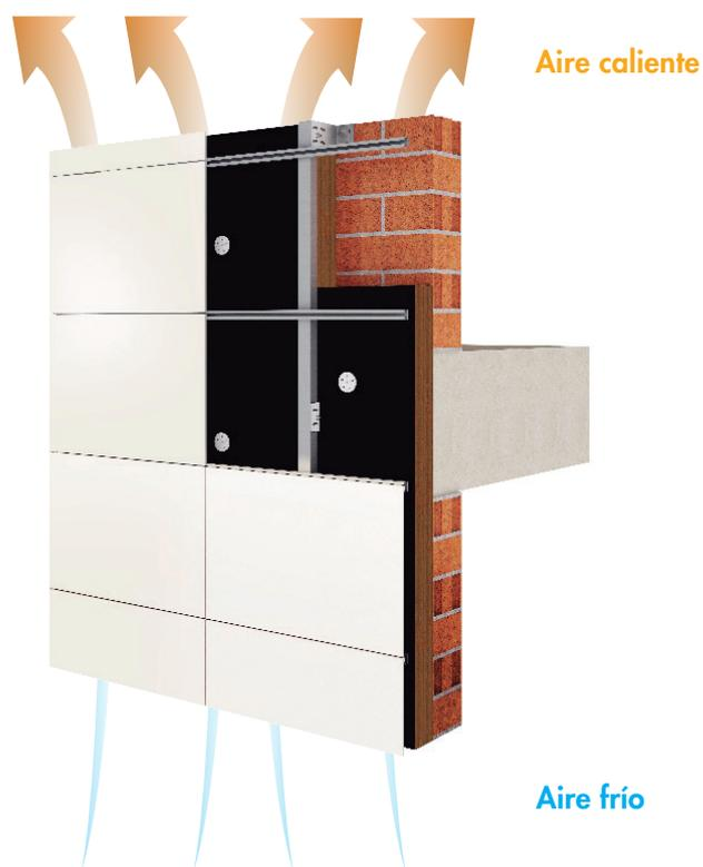
Este tipo de fachada se caracteriza por la existencia de una cámara de aire ventilada, entre el aislamiento y las piezas de acabado, resultante de la colocación de una subestructura metálica fijada a la pared exterior, la cual sirve como base para soportar las piezas de acabado que actúan como segunda piel del edificio.
