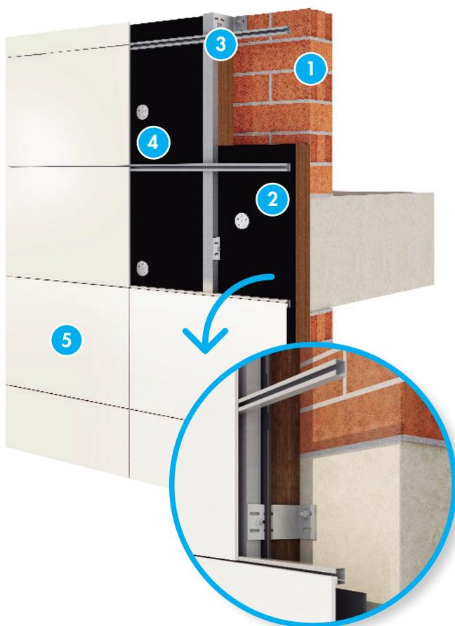
Se compone por un muro soporte, generalmente de fábrica de ladrillo, bloques o paneles de hormigón, sobre el cual se fijan unas ménsulas metálicas, que servirán para la sustentación de la estructura portante del material de revestimiento y acabado de la fachada.
