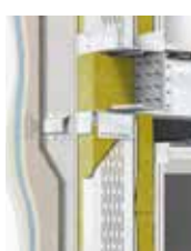
Jednostruka potkonstrukcija, ventilirana - žlijebljeni profili
