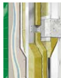
Dvostruka potkonstrukcija s kontinuirano postavljenim profilima
