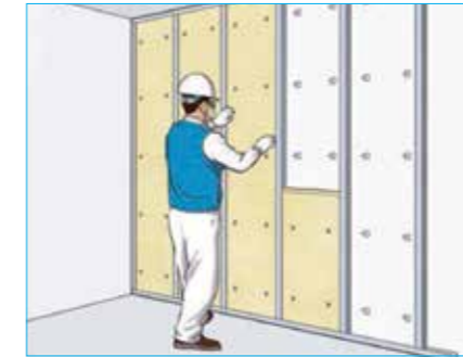
2 단열재 시공(필요 시)
