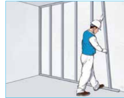
1 상하부 러너 및 스톱드 시공
