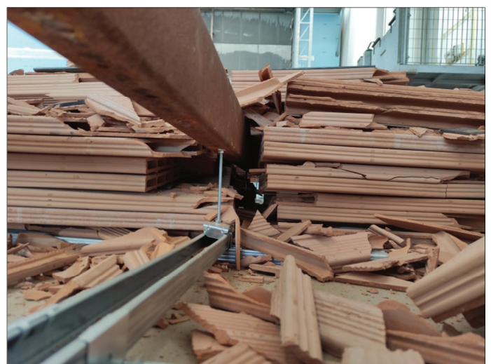
Particolare della base del pendino dopo l'impatto n. 10
