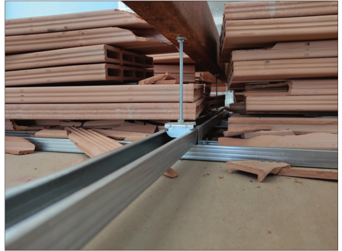
Particolari delle deformazione delle basi dei piedini dopo gli impatti
