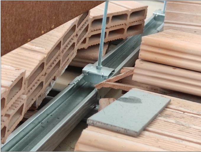
Particolari delle deformazione delle basi dei piedini dopo gli impatti
