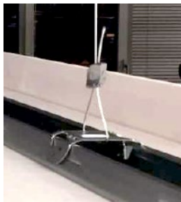
Bild 11: Schlaufenbildung des Drahtseils
