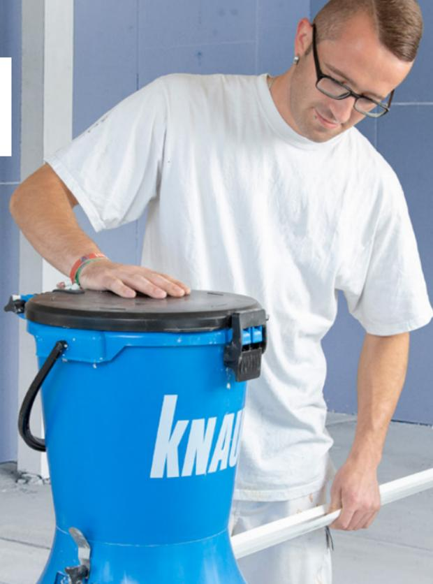
Ecken spachteln kostet Zeit – aber mit dem Spachteltrichter Hopper ziehen Sie in wenigen Sekunden Ihr Material auf Eckschutzprofile wie Dallas (Außenecken) oder Las Vegas (Innenecken) – dann nur noch mit dem Eckenroller drüber und die perfekte Ecke ist unschlagbar schnell gemacht.
