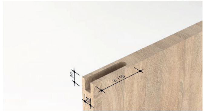
Bild 1: Nut bzw. Türblatteinfräsung zur Montage der verdeckten Türblattaufnahme
