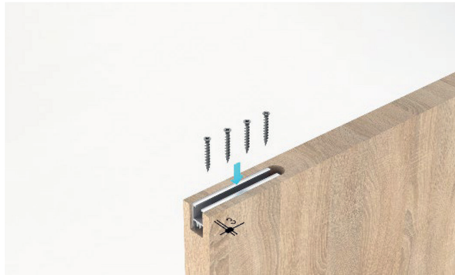
Bild 3: Kurze Aufhängung in den Laufwagen an der Taschenseite und die lange in den Laufwagen an der Türseite schrauben, einen Abstand von ca. 15 mm einhalten.
