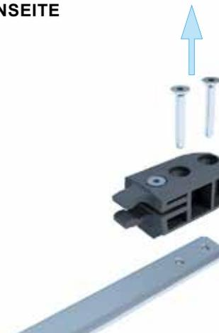
**3** Anschlagstopper und Auslöser an die Verstellhebel anschrauben
