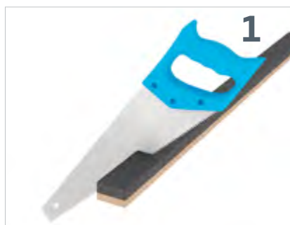
1. Isoleringsstolpen tilskæres med en fintandet sav.
