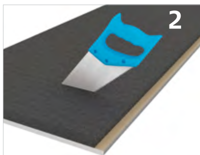
2. Elementerne tilskæres med en fintandet sav. Sav fra forsiden. Skær ud for vinduer og døre inden monteringen.
