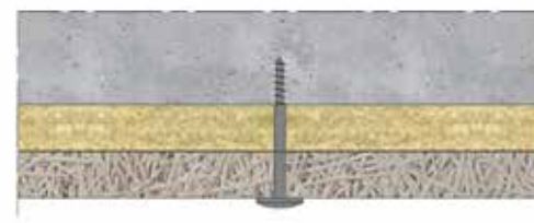
Vastschroeven tegen het beton, paneelmidden
