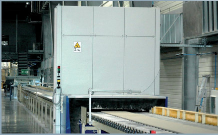
Kontrola produkcji za pomocą skanera rentgenowskiego
