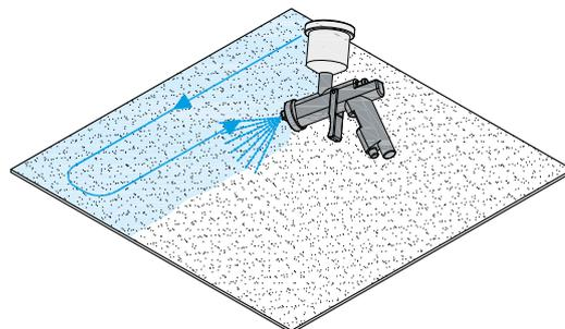
2. Im zweiten Arbeitsgang die Farbe auf die Kanten des Cleaneo Smart 10 Absorberelementes auftragen.
