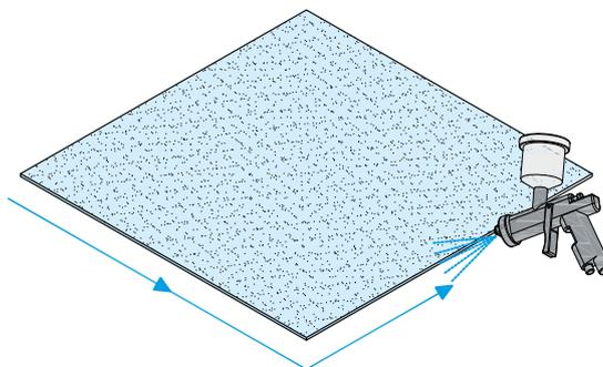
3. Im Anschluss die Farbe quer zum ersten Arbeitsgang im Abstand von ca. 250 mm gleichmäßig auftragen.
