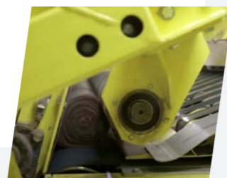
Ci-contre le compactage des isolants en laine de verre
