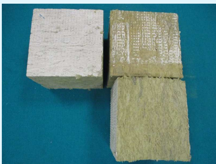
Fotografia di alcuni provini, dall'alto in basso, spessore nominale 80 mm, 120 mm e 180 mm
