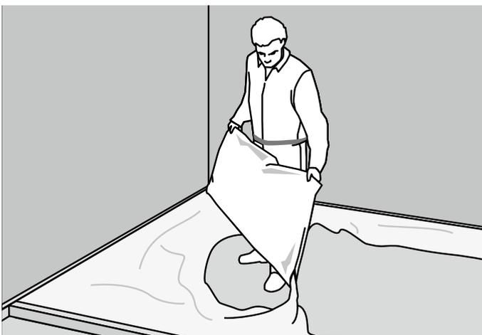
Staubex® wird zwischen zwei Hilfsstreifen geschüttet und mit Abziehlehren oder einer Richtlatte eben abgezogen. Die Mindestschütthöhe von 10 mm (auch über Unebenheiten oder Rohrleitungen) ist zu beachten. Um unerwünschte Verdichtung zu vermeiden, darf die Schüttung nicht betreten werden.
