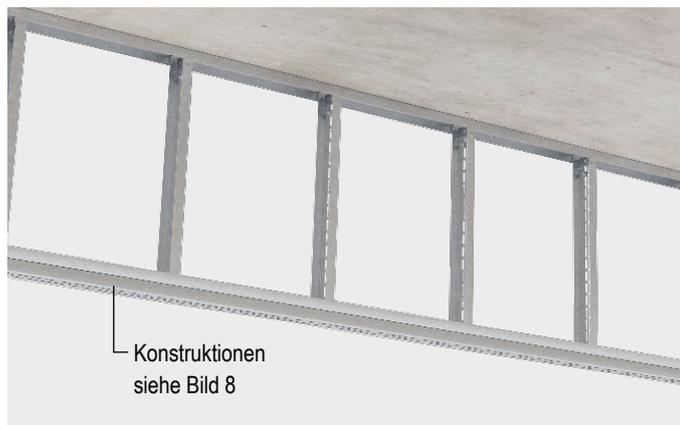
UW-Profil-Konstruktion aufstecken, sichern und Fluchtlinie kontrollieren.
