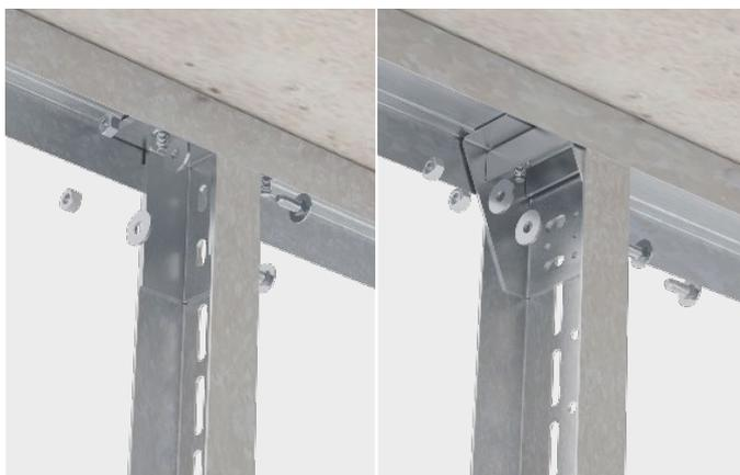
UA-Profil auf erforderliche Länge zuschneiden. Auf Stützenfuß bzw. Konsolwinkel aufstecken und mittels 2 beigelegten M8 Schrauben mit Unterscheiben und Muttern handfest sichern. Justierbarkeit der Profile zum Ausrichten muss gegeben sein.
