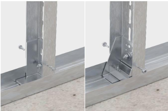
UA-Profil mittels 2 beigelegten Bohrschrauben seitlich in Stützenfußwange bzw. Konsolwinkelflansch verschrauben. Anschließend M8 Schrauben festziehen.
