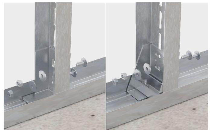
UA-Profil auf erforderliche Länge zuschneiden. Auf Stützenfuß bzw. Konsolwinkel aufstecken und mittels 2 beigelegten M8 Schrauben mit Unterlegscheiben und Muttern handfest sichern. Justierbarkeit der Profile zum Ausrichten muss gegeben sein.
