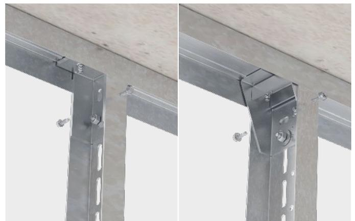
UA-Profil mittels 2 beigelegten Bohrschrauben seitlich in Stützenfußwange bzw. Konsolwinkel flansch verschrauben. Anschließend M8 Schrauben festziehen.
