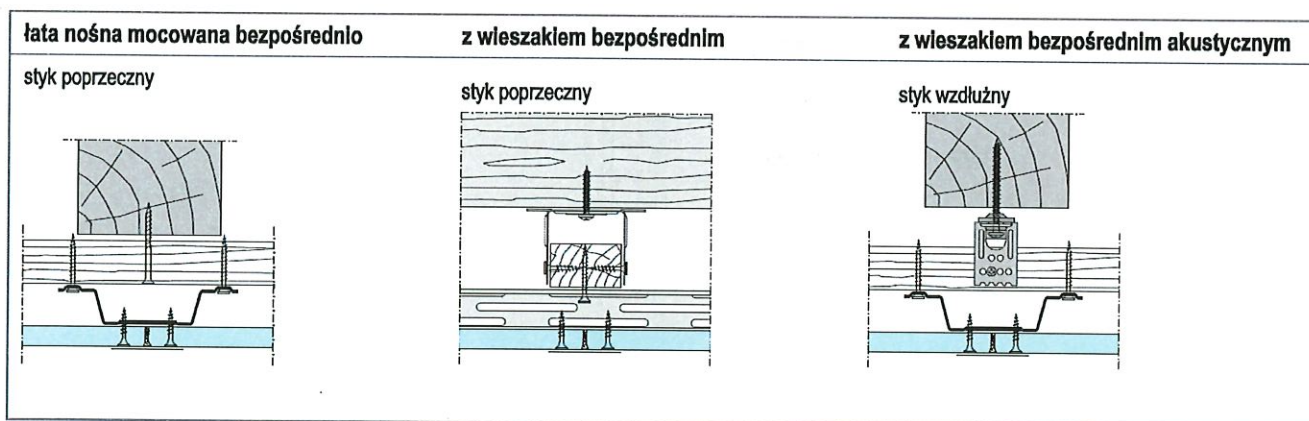
Rysunek 23. System D613.pl na konstrukcji krzyżowej z łąty drewnianej oraz z profilem sprężystym.
