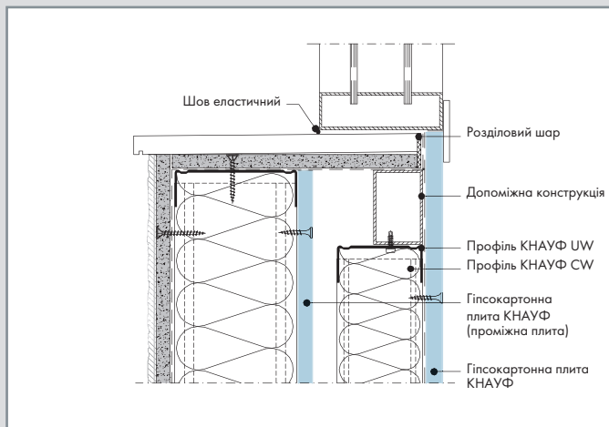
W387E-FE-VU2 Примикання до вікна, варіант 2
