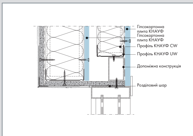
W387E-FE-VO2 Верхнє примикання до вікна, варіант 2
