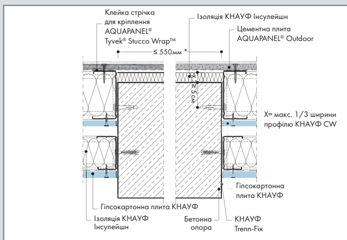
W387E-HS1 Перехід і примикання до залізобетонної опори
