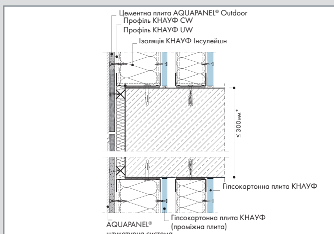
W387E-VM1 Горизонтальний компенсаційний шов
