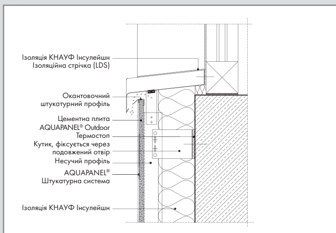
W684T-FE-VU1 Навісний фасад, нижнє примикання до вікна
