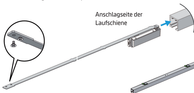
Bild 4: Montage „Push to open“ Einsatz
