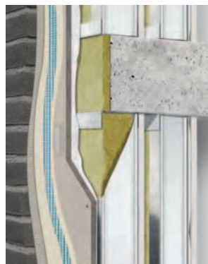
Kettős vázszerkezet impregnált gipszkarton köztes lemezzel
