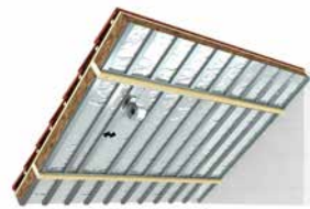
STAP 3 - Luchtdicht en dampremmend maken
