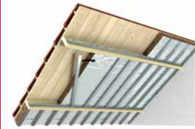
STAP 2 - Staanders en isolatie plaatsen
