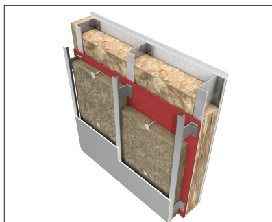
Ventilerad fasad - Stålrregelstomme
