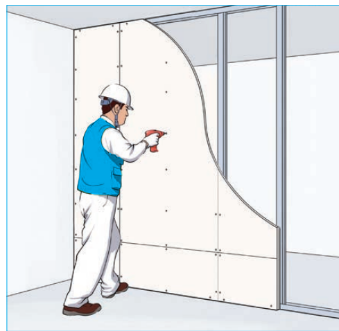
3 바탕면에 석고보드 시공
