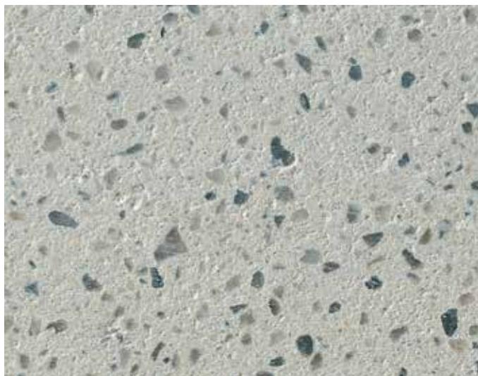
Joonis 65: Knaufi valupõranda ristlõige, 4 korda suurendatud
