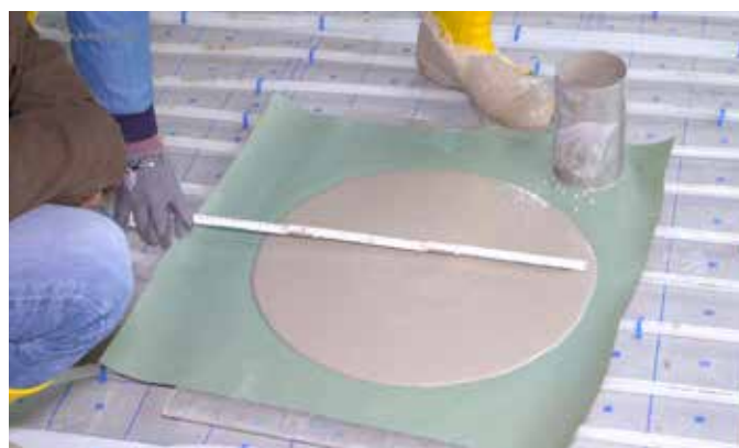
Joonis 48: Läbimõõdu mõõtmine
