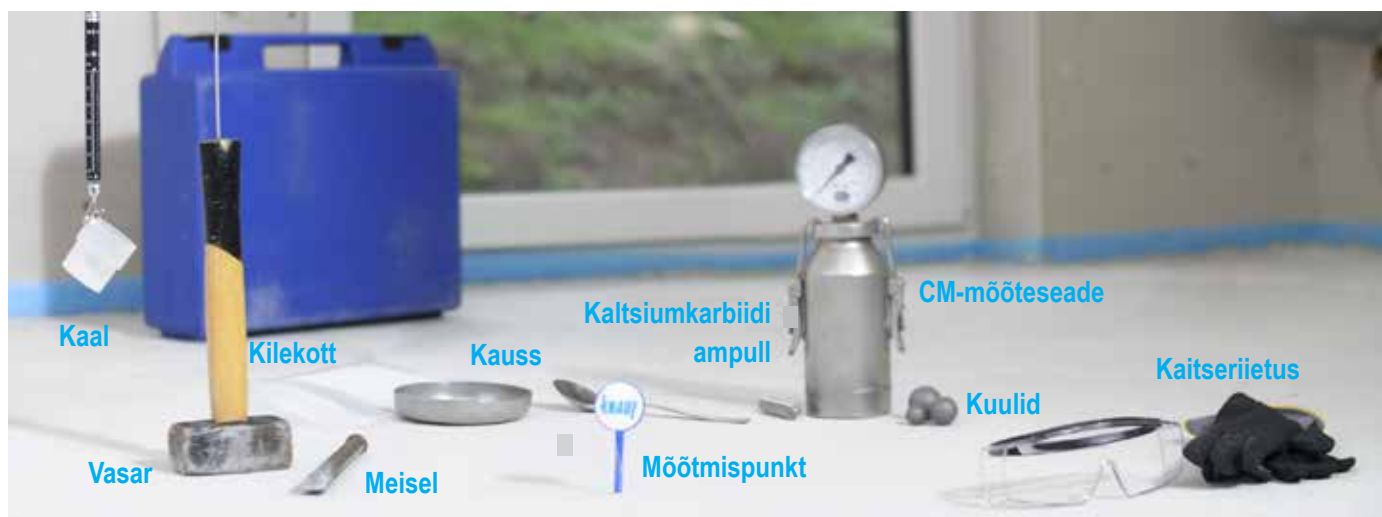
Joonis 64: Põrandakatte paigaldamiseks valmisoleku kontrollimine CM-seadmega
