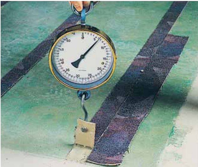
Joonis 68: Prooviliimimine ja lindikatse
