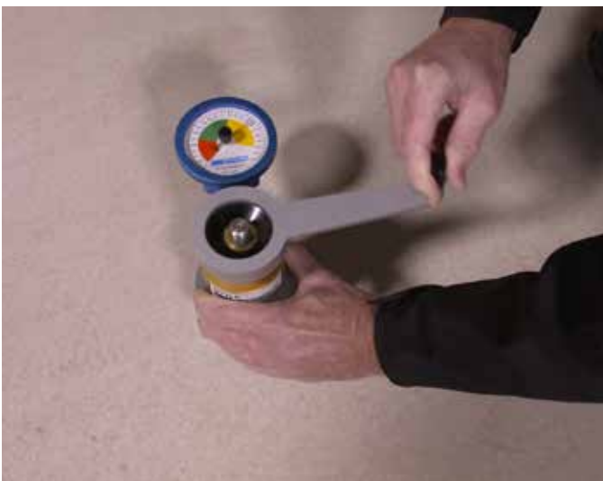
Joonis 69: Nakketugevuse kontrollimine
