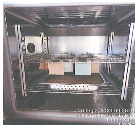
Vị trí mẫu thử trong buồng thử nghiệm (Position of Specimens in the test chamber)
