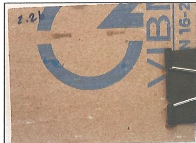
Hình ảnh hai mặt của mẫu thử sau khi phơi nhiễm nấm 7 ngày (Two-sided image of test samples after 7 days of exposure)
