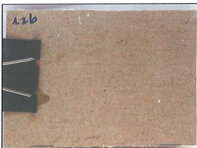
Hình ảnh hai mặt của mẫu thử sau khi phơi nhiễm nấm 7 ngày (Two-sided image of test samples after 7 days of exposure)
