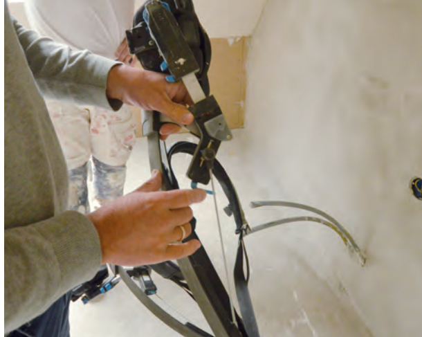
Het exoskelet werkt met arm-ondersteunende veren.
