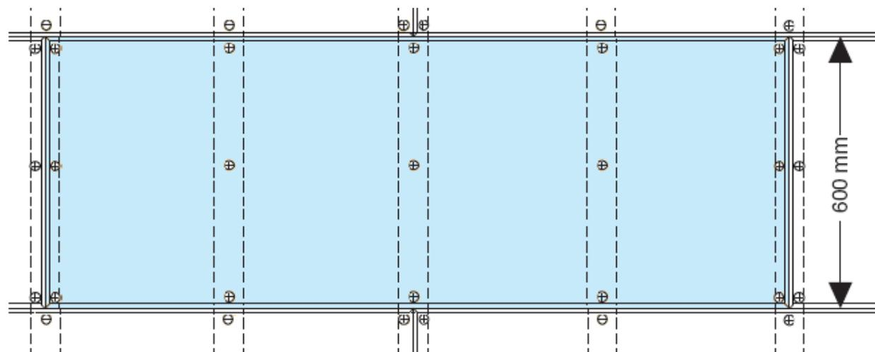
Dans le cas de risque de jets de ballons l'entraxe de 600 sera réduit à un entraxe d'ossature  $\leq 300$ mm.
