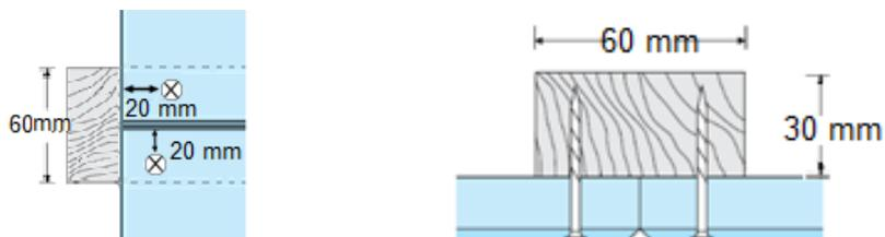
Panneaux de 25 mm : vis TX Drive de 45 mm
