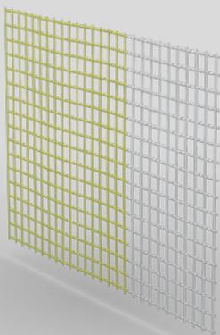
Armature en fibre de verre pour le renforcement global des mortiers d'armature Knauf (SupraCem) principalement dans le cadre de systèmes de façade isolante Knauf Komfort-Wall, ou pour le renforcement local au droit des zones fragiles (angles de baie). Le treillis est livré sous la forme de rouleaux reconnaissables par deux bandes latérales de couleur verte-olive.
