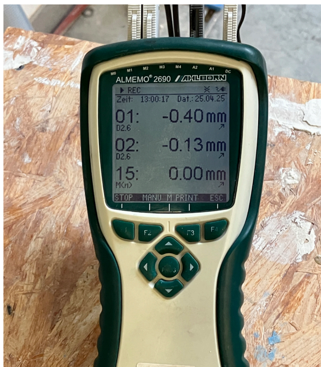
01 per il sensore sotto la piastrella, 02 per il sensore sul profilo
