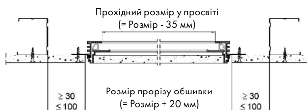
Схематичне креслення люка с захистом від бризок
