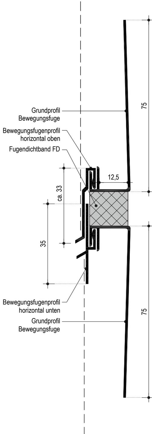
Zur Abdichtung an angrenzende Bauteile und zur Herstellung der horizontalen Bewegungsfuge muss ein Fugendichtband auf das Grundprofil Bewegungsfuge aufgeklebt werden.
