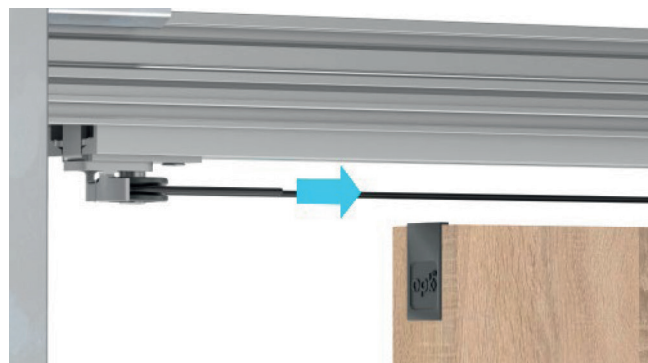
Bild 26: Einfädeln des Seils um die Umlenkrolle
