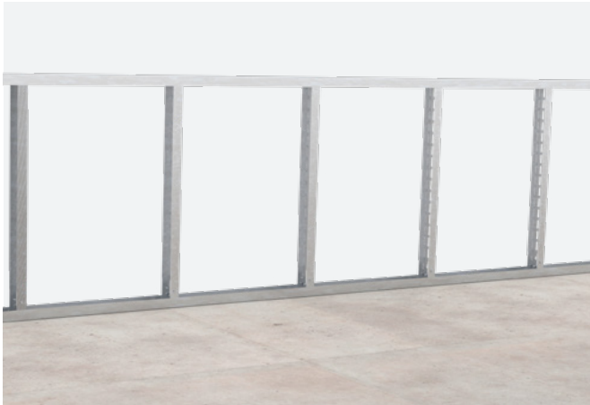
7 pav. Viršutinio UW profilio montavimas
