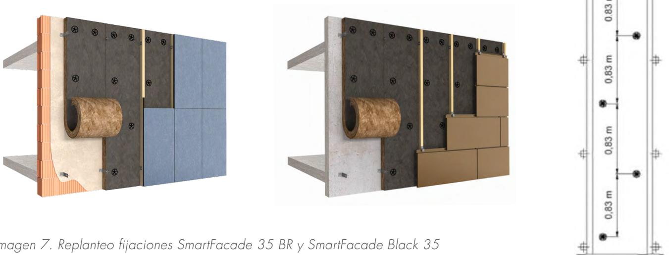
Imagen 7. Replanteo fijaciones SmartFacade 35 BR y SmartFacade Black 35
