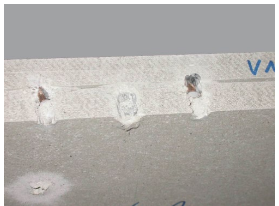
Versuchskörper nach Durchschussprüfung
