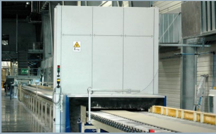
Produktionskontrolle mit dem Röntgenscanner
