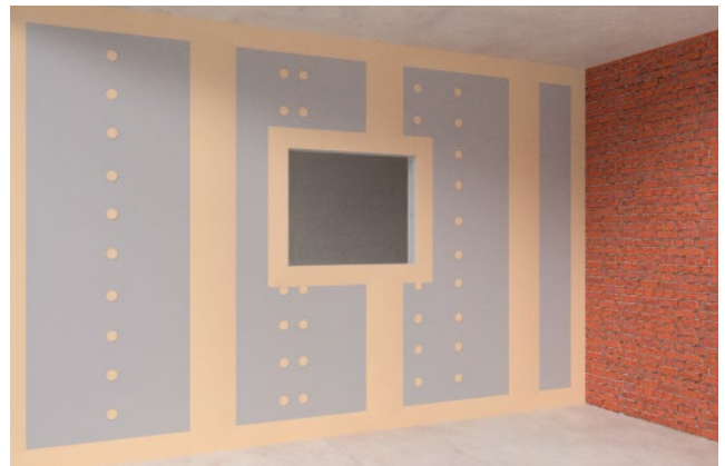
Bild 15: 2. Beplankungslage und vollständige Verspachtelung beider Seiten
