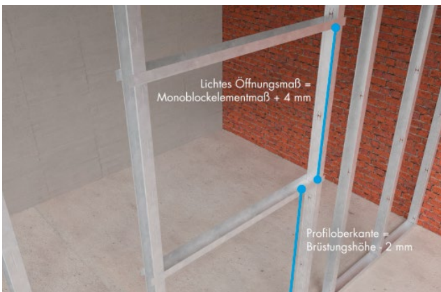
Bild 7: UW-Sturz- und -Brüstungsprofile einbauen
